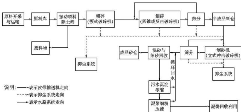
图 A.2.3-2 湿法制砂生产工艺流程
