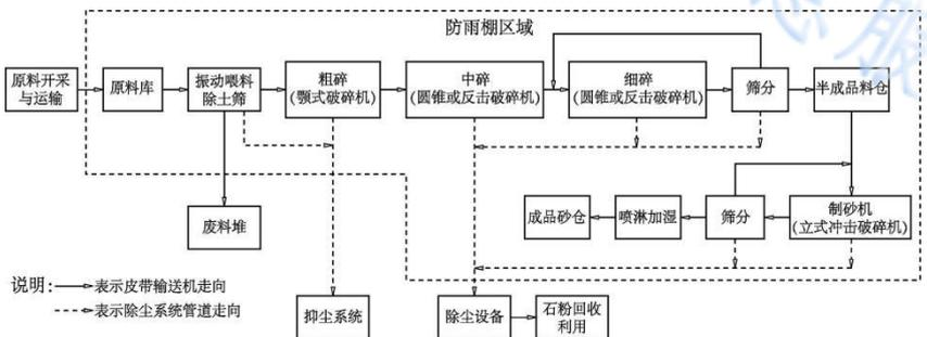
图 A.2.3-1 干法制砂生产工艺流程
